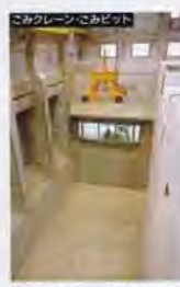
ごみピット内に一旦貯留されたごみは、ごみクレーンで搬送され、投入ホッパーから焼却炉へ投入されます。
